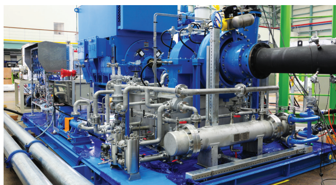
Компрессор технологического газа для завода по производству удобрений
